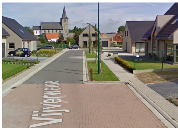
Links: Nabij de Sint-Vedastuskerk te Nederename is nog heel wat marge te ontharden. Rechts: in de Vijverweide vloeit het regenwater af naar de riolering ipv naar de groenzone omwille van de borduur (Bron: Google street view).
