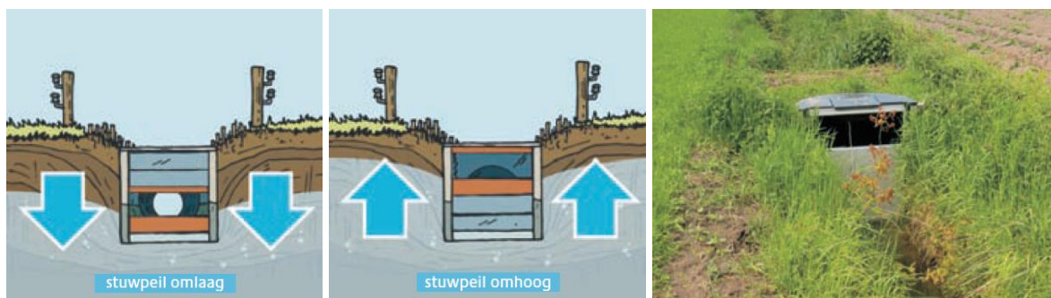
Principe van perceelsgrachten uitgerust met stuwjes (Bron: Sumaqua & ZES, 2021).
